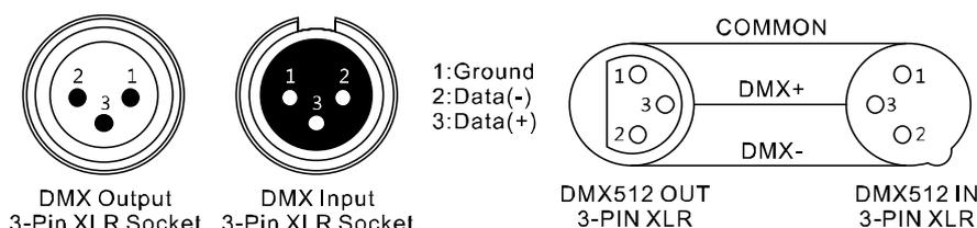
Für Anlagen mit sehr langen DMX-Kabelwegen oder hohen elektrischen Störeinflüssen, wie zum Beispiel in einer Diskothek, ist es empfehlenswert, einen DMX-Terminator zu verwenden. Der DMX-Abschlusswiderstand wird in einem XLR-Stecker als 120 Ω Widerstand zwischen Pin 2 und 3 ausgeführt der in die letzte Ausgangsbuchse der
