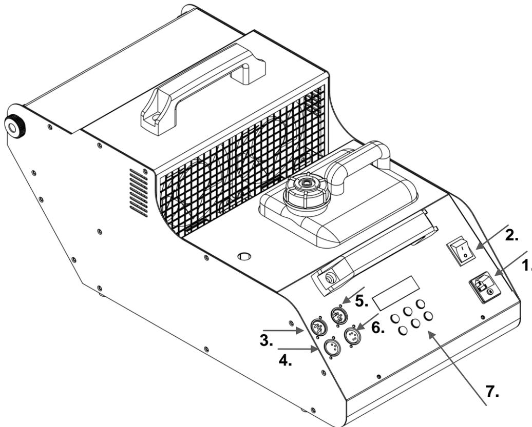
**1. POWER IN:** IEC Stromeingangsbuchse mit Sicherungshalter für F6,3AL230V Sicherung.
