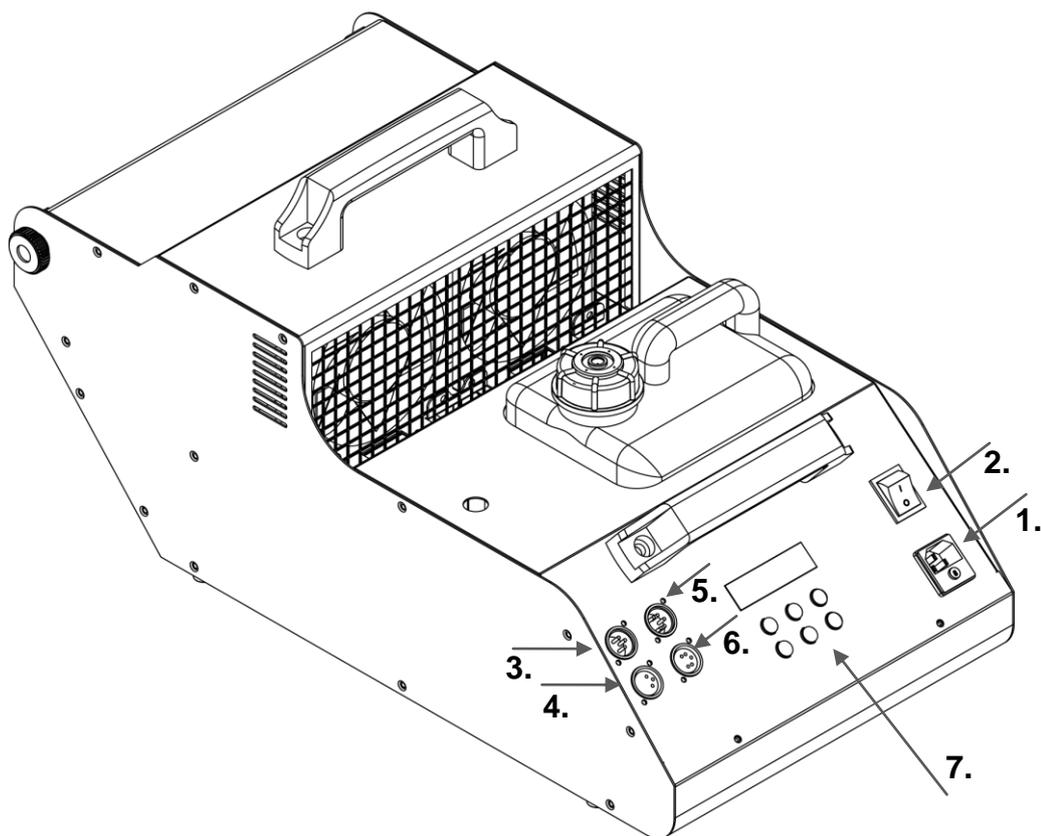
**1. POWER IN:** входной разъем питания IEC переменного тока с предохранителем F6,3AL230V.
